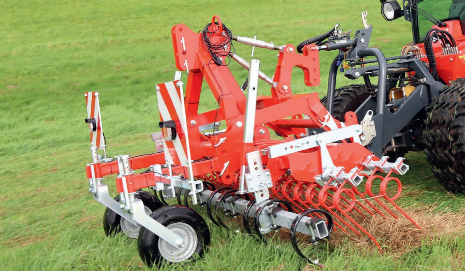
GreenMaster 300 Alpin a gáton lévő gyepek karbantartásához. Elöl borona, hátul prizmahenger® pneumatikus vetőgéppel és 8 szórótányérral. Kiegyensúlyozott súlyelosztás - lejtőkön is stabil munkavégzés.
