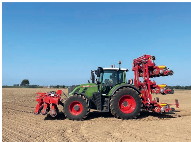
Minden Mediana vízszintesen előre hidraulikusan összecsukható. A képen egy Mediana 820/900 látható - nagyon jól áttekinthető a közúti forgalom.
