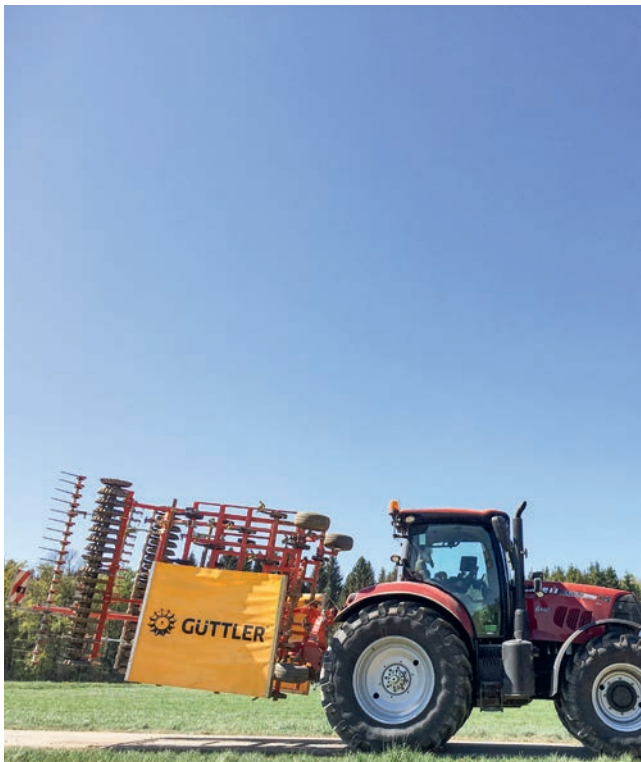
SuperMaxx® CULTI: Szállítási szélesség 2,50 m - biztonság az úton.
