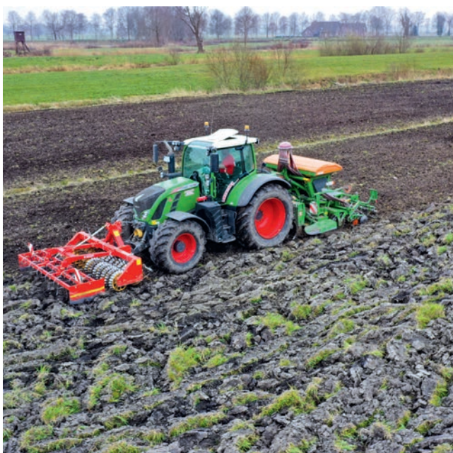
Egyenetés és visszatömörítés elől = sekély traktornyom = sekély művelés. Kevés nedves talaj kerül a felszínre.
