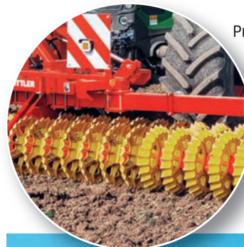
DUPLEX® 30-45 kapafogas előtéttel. Ami ősszel a szántott talajon jól működik, az egy száraz tavasszal is nagy hasznot hoz..
