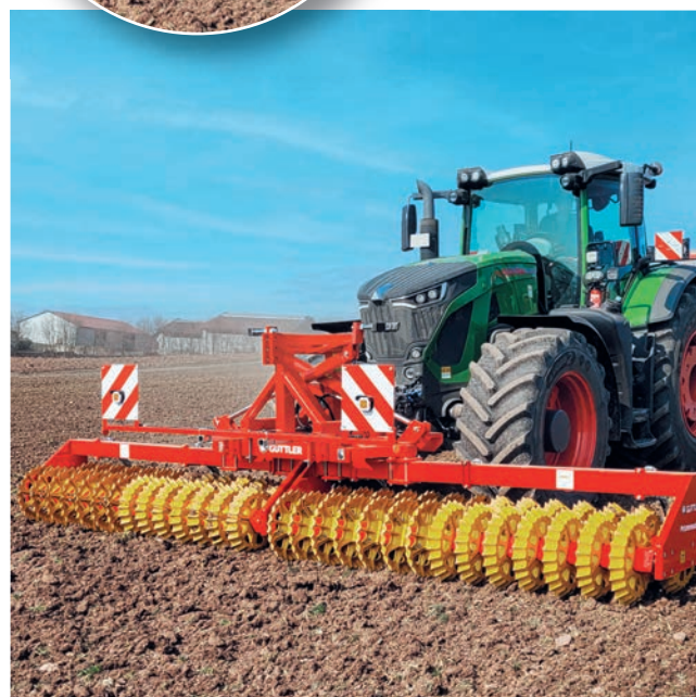
Egyenetés és visszatömörítés elől = sekély traktornyom = sekély művelés. Kevés nedves talaj kerül a felszínre.
