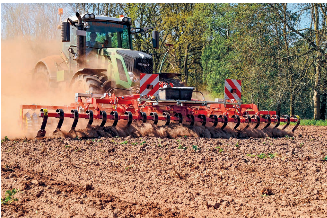
A 6,15 m munkaszélességű Avant 610 hidraulikusan állítható FlatSpring simító előtéttel van felszerelve a rögtöréshez. Nagy területteljesítmény a tavaszi talajműveléshez.
