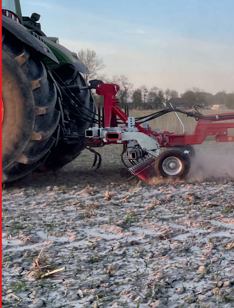
GÜTTLER® Mayor prizmahenger® - iszaposodott talaj őszi búzával, a fiatal növények részben eliszapolódtak és a kéreg alatt fekszenek.
