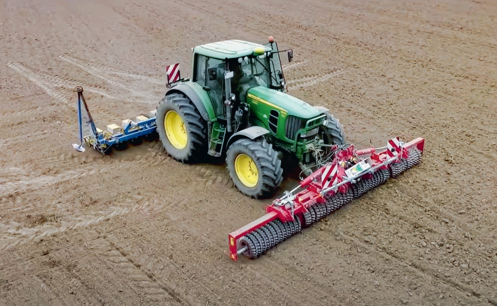
Morzsalékos szerkezet kialakítása és visszatömörítés előtt - pontos vetőmag elhelyezés - Gütler magágy.
